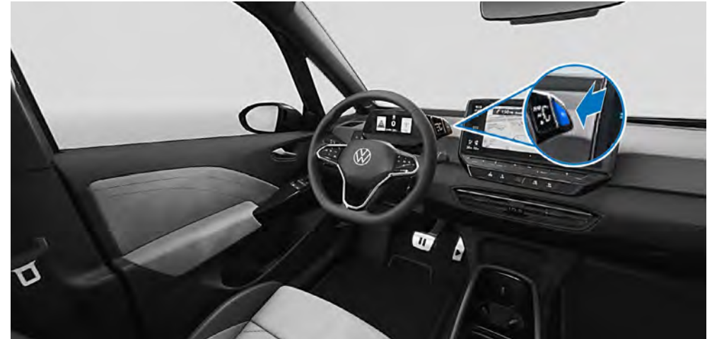
Actionner le frein de stationnement électrique sur le commodo droit.
