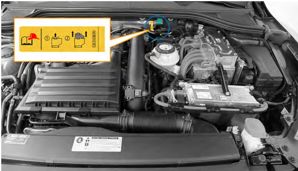
Point de couplage à l'avant des véhicules hybrides (Golf GTE à partir de 2020), voir aussi Nouveau marquage à partir de l'ID.7.
