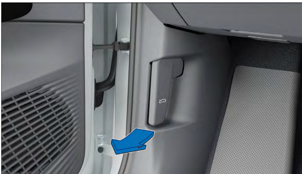
Dans le plancher côté conducteur : levier de déverrouillage du capot avant (exemple ID.4).
