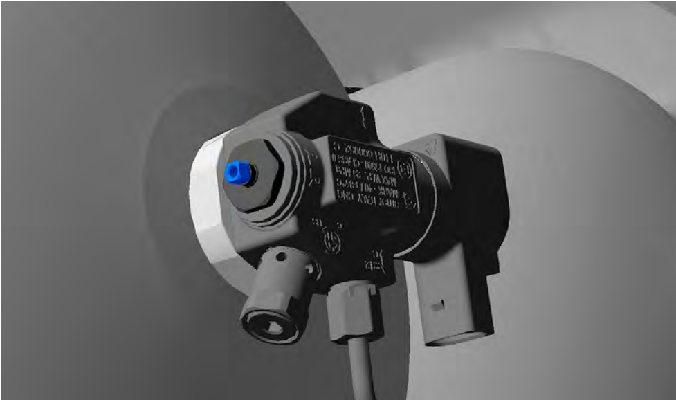
Avec une clé à fourches de 5 mm, une pince ou un outil spécial, tourner la vanne de coupure dans le sens horaire jusqu'à la butée.
