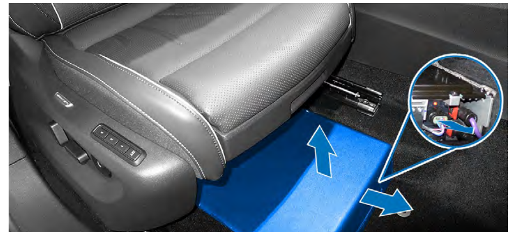
Débrancher le réseau de bord 48 V sur le Tiguan à partir de 2023.
