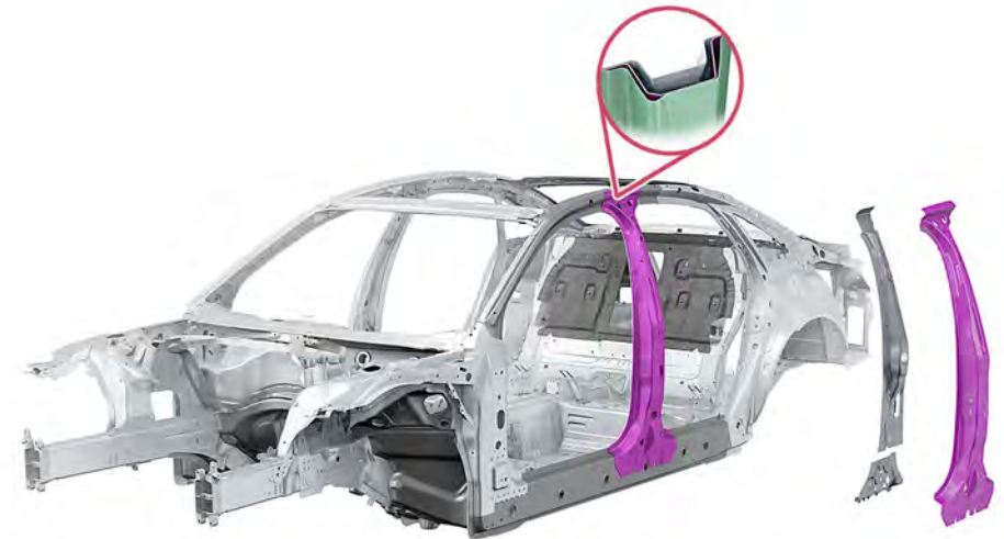
Montant B avec structure multicouche
