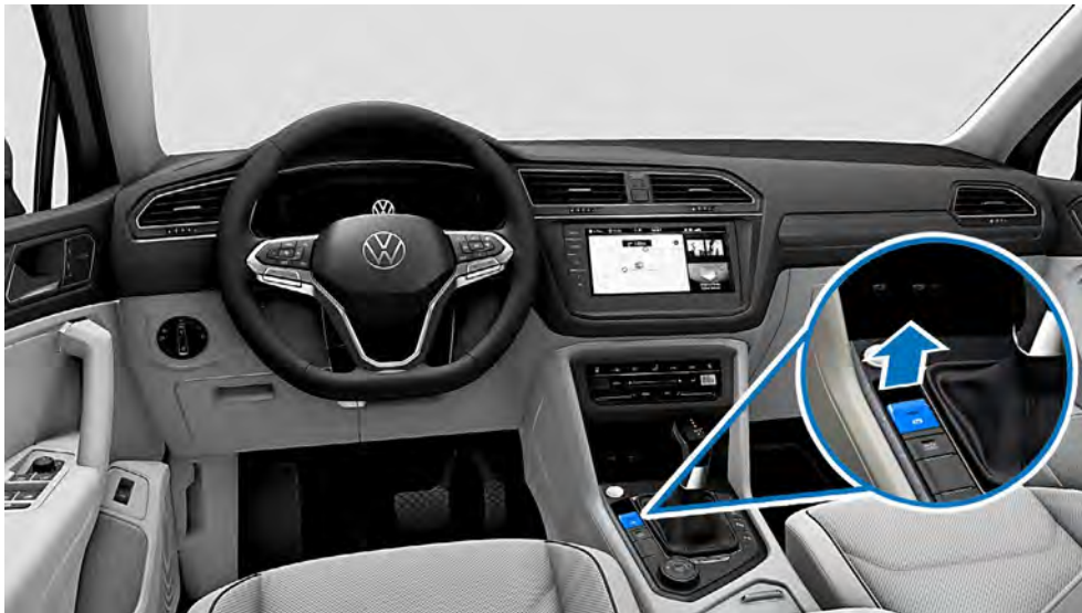
Véhicule conventionnel avec boîte automatique : actionner le frein de stationnement électrique ou tirer le levier de frein à main.
